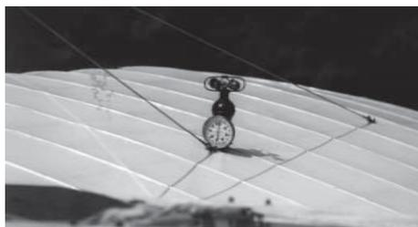
*Geschwindigkeitsmessung für die Testflüge*
