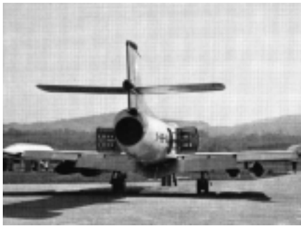
P-16 MK III. Sturzflugbremse ausgefahren, Querruder abgesenkt, Landeklappen ausgefahren, Bremsschirmbehälter geöffnet
