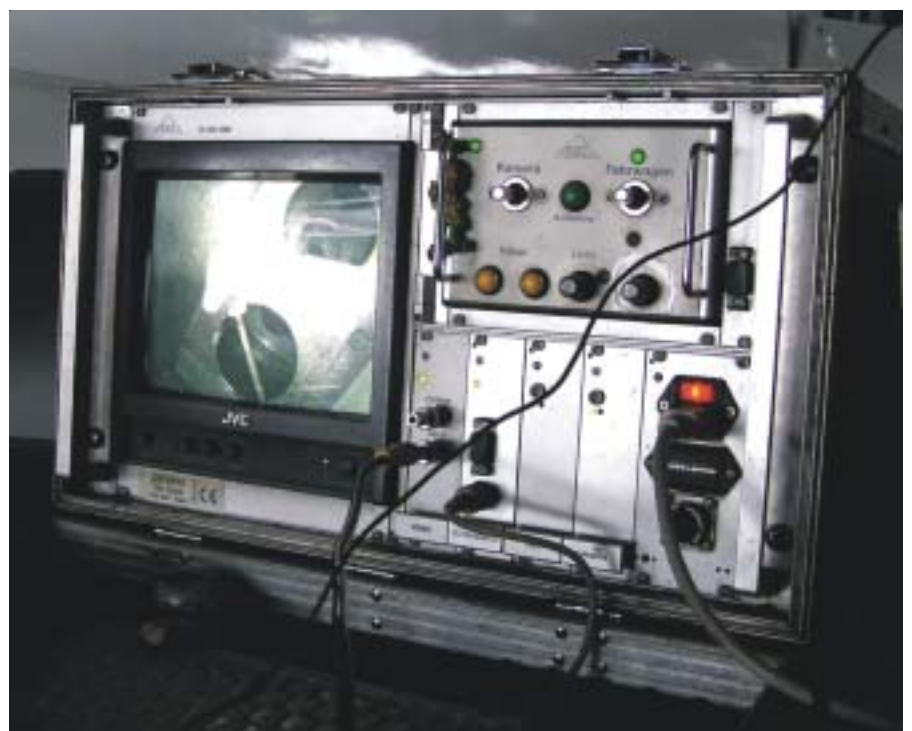
Erstmals wurde mit einer Kamera die Metallanschlüsse, Leimstellen und Stoffkanten überprüft – alles im gutem Zustand
