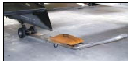
Schleppvorrichtung bestehend aus: Rostfreien Profil-Teilen vom Bastlerlädli, Teilen von der Triebwerkaufhängung B747 Swissair, Räder vom B747 Upper-Deck Cargo-Loading ex Cathay-Pasific Airline, Sandsack ex SAS-Airline, Schrauben, Bolzen vom Coop-Baucenter, Bügel vom Harley-Motorrad usw.
