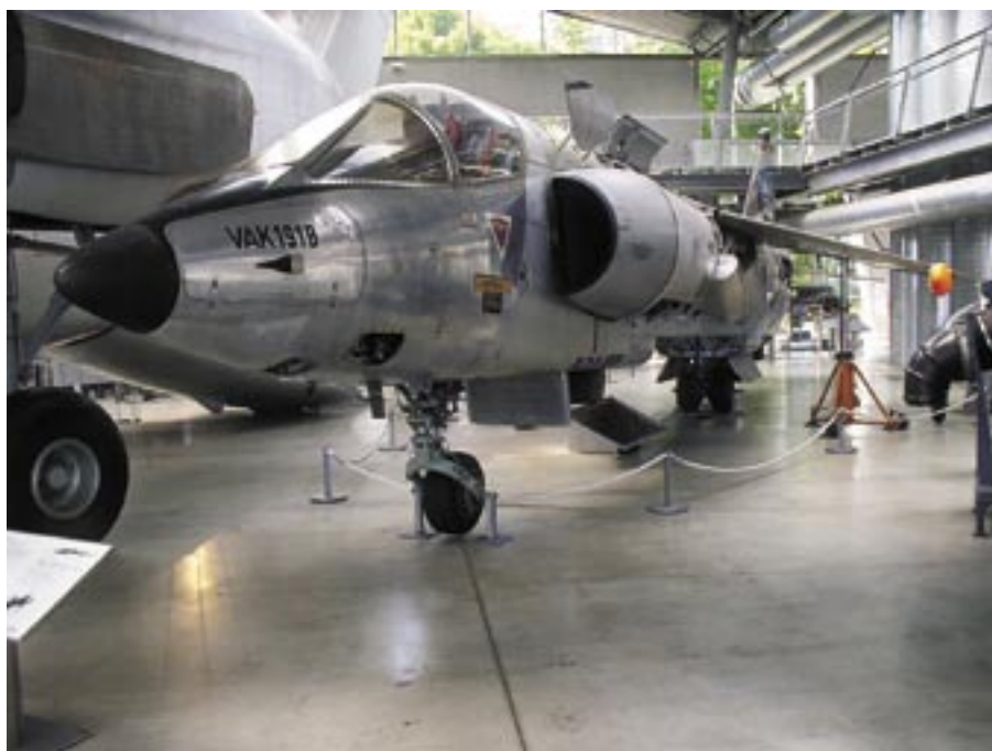
Die VAK 191 war als senkrechtstartfähiges Kampfflugzeug konzipiert. Ein Marsch- und zwei Hubtriebwerke trieben dieses internationale Projekt an, das aber nach dem Ausstieg Italiens nicht weiterentwickelt wurde. Die VAK 191 diente dann als Erprobungsträger für den Tornado.
