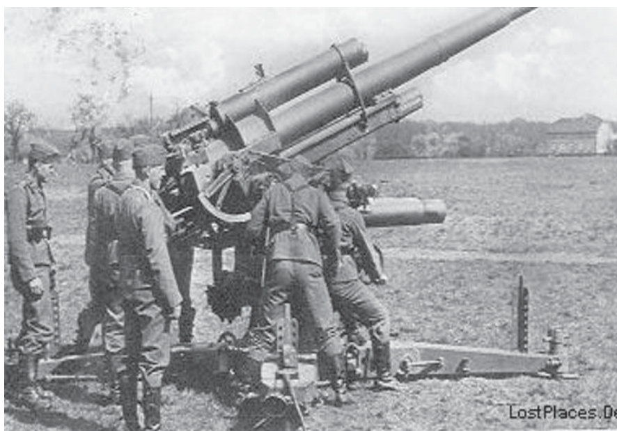
Die 7,5-cm-Kanone beim Schiessen. Links vom Rohr sieht man ein Geschoss, das in der Tempier-Maschine eingestellt wird.
