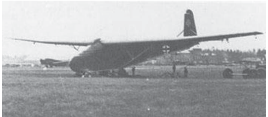
Dieser Me 321 Lastensegler gab den Ausschlag - 18 Tonnen Leergewicht, Zuladung 22 Tonnen, Spannweite 55 Meter - und das war die Antwort - die fünfmotorige Henschel He111Z - Startleistung 6700 PS, maximales Startgewicht 28.6 Tonnen, Flügelspannweite 35.4 Meter
