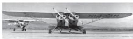
Eine Twin-Variante des Piper Cubs. Der rechte Propeller war etwas nach vorne versetzt, damit sie sich nicht in die Quere kamen.
