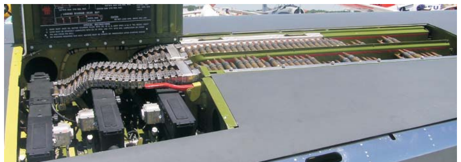
Die drei MGs der Mustang im rechten Flügel.
