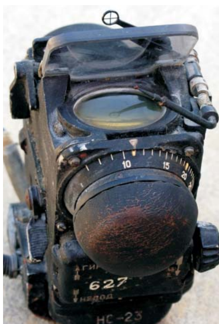
Das Gerät besteht aus zwei unabhängigen Systemen. Ein gewöhnliches ReVi und ein System, welches durch die Fliehkraft beeinflusst wird. Dieses besteht aus sechs in einem Kreis mit einem Punkt in der Mitte angeordnete rhombenförmigen Rauten.
