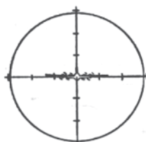
Eine Fortress! Spannweite rund 30 m Passt 2 x in den Kreis 30 x 2 x 10 = 600 m Näher ran!
