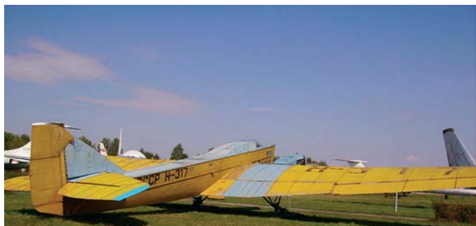
Die ANT-4, das weltweit erste mehrmotorige Ganzmetall-Flugzeug mit freitragenden Flügeln.
