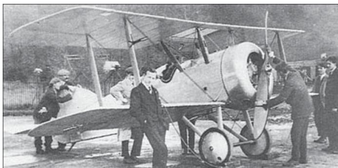
*Die Vickers war mit einem 100 PS Gnome bestückt. 1916 wurden einige F.B.19s nach Russland geliefert. Sie wurden mit neuen Motoren ausgerüstet, Le Rhone oder Clerget 110 PS Sternmotoren, und erhielten die Bezeichnung F.B Mk II.*
