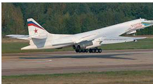
Die Tu-160, Startgewicht 275 Tonnen (B-52, 221 Tonnen) und verfügt über zwei Bombenschächte mit jeweils einem Revolvermagazin. Es können 12 mit nuklearen Gefechtsköpfen bestückte Marschflugkörper Ch-55SM, Ch-555 oder Ch-101 mitgeführt werden. Für konventionelle Luftangriffe können 24 Luft-Boden-Raketen der Typen Ch-15 eingesetzt werden. Nach dem Modernisierungsprogramm sollen Ch-58USchKB, Ch-38, Ch-29T, Ch-29ML, Ch-59M, Antiradarraketen Ch-31P, Antischifftraketen Ch-31-AD oder Ch-35U sowie Bomben KAB-1500 und KAB-500 eingesetzt werden können. Die maximale Waffenlast liegt bei zirka 40.000 kg.
