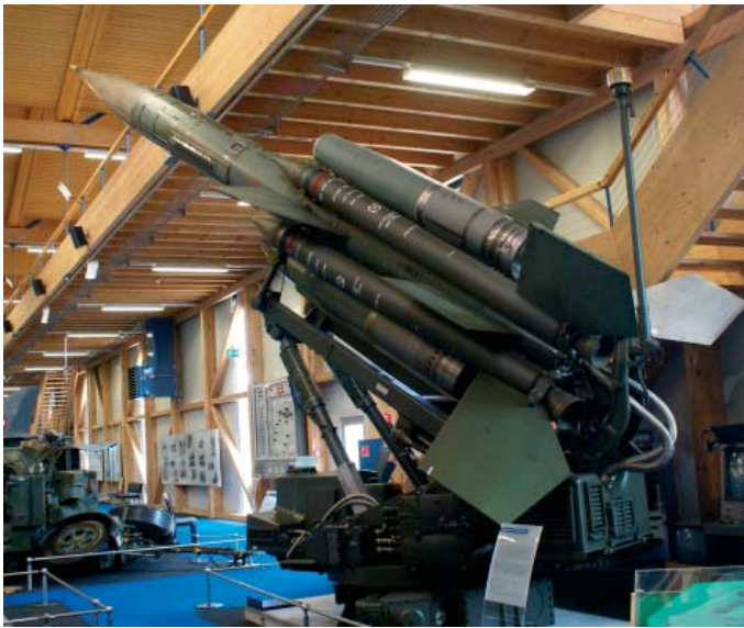
(li) Die Bloodhound Mk II BL-64 mit 4 Feststoff-Start- raketen (total 50'000 kg Schub) und 2 Marsch-Staustrahltrieb- werken mit je 3'600 kg Schub ) und die Florida-Leitstelle
