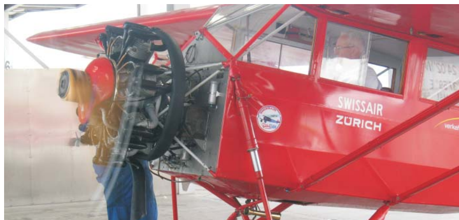
Der revidierte «Amstrong Sideley» im AC-4 ist erwacht, Standlauf am 22. 4. 2010 in Dübendorf
