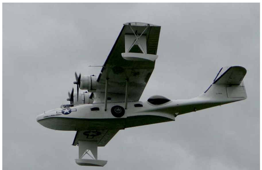
Die Catalina - Aufgrund der grossen Reichweite (die «Catalina» konnte bei 200 km/h fast 24 Stunden in der Luft sein) war die PBY für die Fernaufklärung und die Sicherung von Geleitzügen geeignet. Sie wurde aber auch zur Seenot-Rettung eingesetzt, wo sie Leben von tausenden über dem Pazifischen Ozean abgeschossenen Crewmitgliedern rettete. Ferner wurde sie als U-Boot-Jägerin verwendet. Selbst zur Brandbekämpfung und Luftbetankung wurde sie eingesetzt
