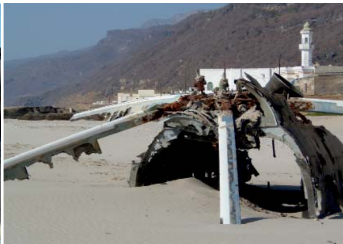
Das Heckteil des Helikopters ist abgebrochen. Ein Teil des Schwanzes liegt neben dem Wrack. Im Hintergrund die Moschee von Dhalkut.
