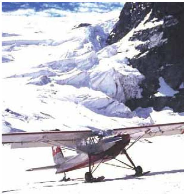
ausgerüstet war, bekam die zweite XL-60 das in die Serienproduktion übernommenen Praga Doris B Triebwerk mit 220 PS. Sie startete erstmals am 22. März 1955. Die L-60 war ein abgestreifter Schulterdecker in Ganzmetall-Schalbauweise, nur die Ruder des Leitwerks waren stoffbespannt.
