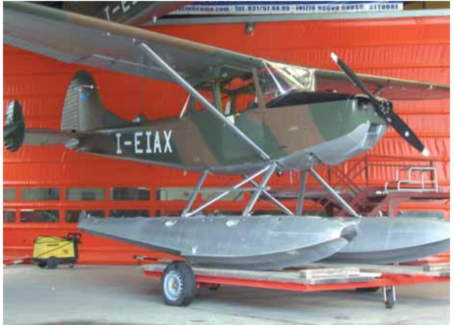
Oben: Die Cessna O-1E Bird Dog (305C/L-19E) in Como war während unserem Besuch leider nicht auf dem Wasser oder in der Luft zu bewundern, da gerade Unterhaltsarbeiten anstanden Links: Dank den Wartungsarbeiten hatte man jedoch einen schönen Blick auf den Continental O-470-11-Motor des historischen Flugzeugs [Fotos: Kuno Gross]
