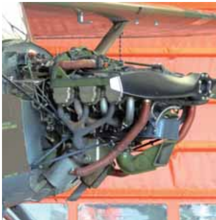
Oben: Die Cessna O-1E Bird Dog (305C/L-19E) in Como war während unserem Besuch leider nicht auf dem Wasser oder in der Luft zu bewundern, da gerade Unterhaltsarbeiten anstanden Links: Dank den Wartungsarbeiten hatte man jedoch einen schönen Blick auf den Continental O-470-11-Motor des historischen Flugzeugs [Fotos: Kuno Gross]
